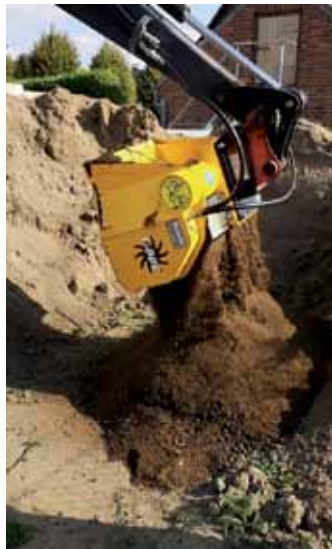
GyruStar: Sternsieblöffel zur Feinabsiebung von Mutterböden
