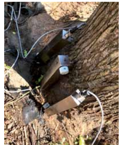
Foto 9: Für Baumuntersuchungen mit speziellem Zugverfahren (Inclino-Elasto-Methode) wurde die Messtechnik am Stammfuß angebracht. Foto: Stülpnagel, Blattwald
